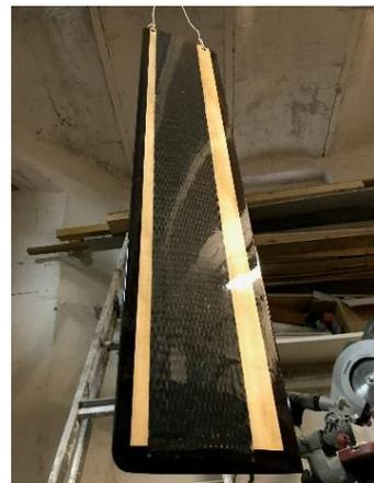
La cassette de safran a été réalisé en deux demies coquilles bois, assemblées par bandes UD Carbone tube Carbone pour la barre.
